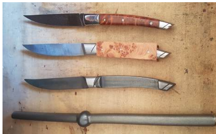
Étapes de forge du couteau de table Le Thiers Prestige de Goyon-Chazeau, labélisé Entreprise du patrimoine vivant (EPV) pour la fabrication de couteaux de table et de cuisine 100 % forgés. Stages in forging the Le Thiers Prestige knife at Goyon-Chazeau, bearing the French Living Heritage Entreprise label for its 100% forged manufacturing of table and kitchen knives.
